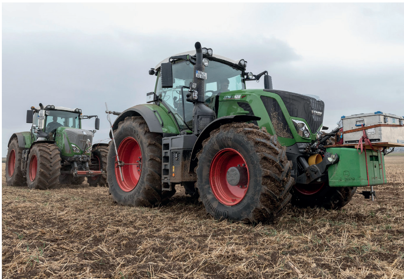
Bild 2: Zugschlepper und Bremsschlepper bei der Bestimmung der Traktions- bzw. Kraftstoffeffizienz auf dem Feld
