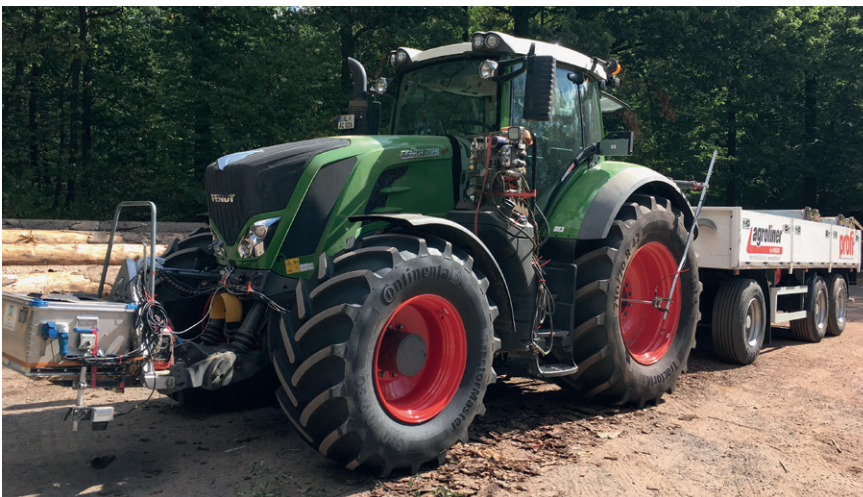
Bild 8: DLG-Transportfahrt zur Bestimmung der Kraftstoffeffizienz auf der Straße
